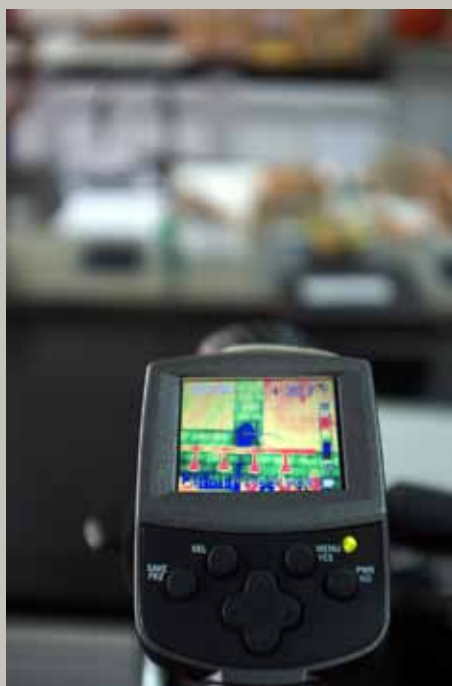
Una cámara de infrarrojos que se utiliza para estudiar la composición de los materiales
